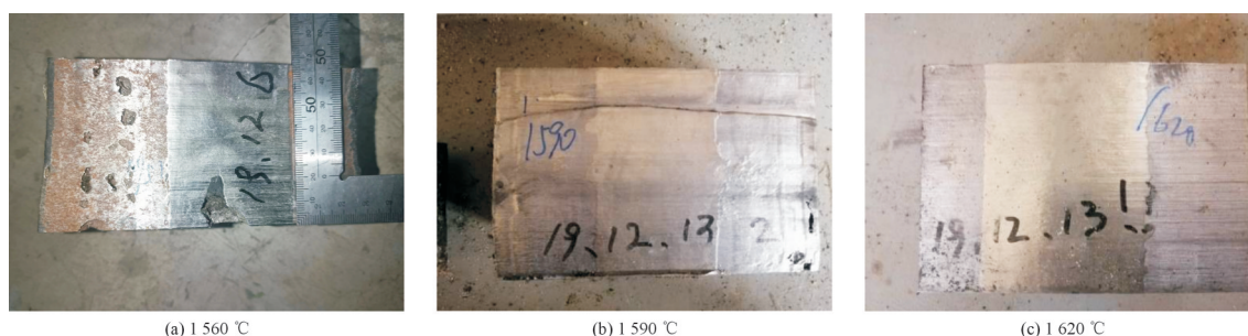
图3 不同浇注温度下复合坯剖面照片
